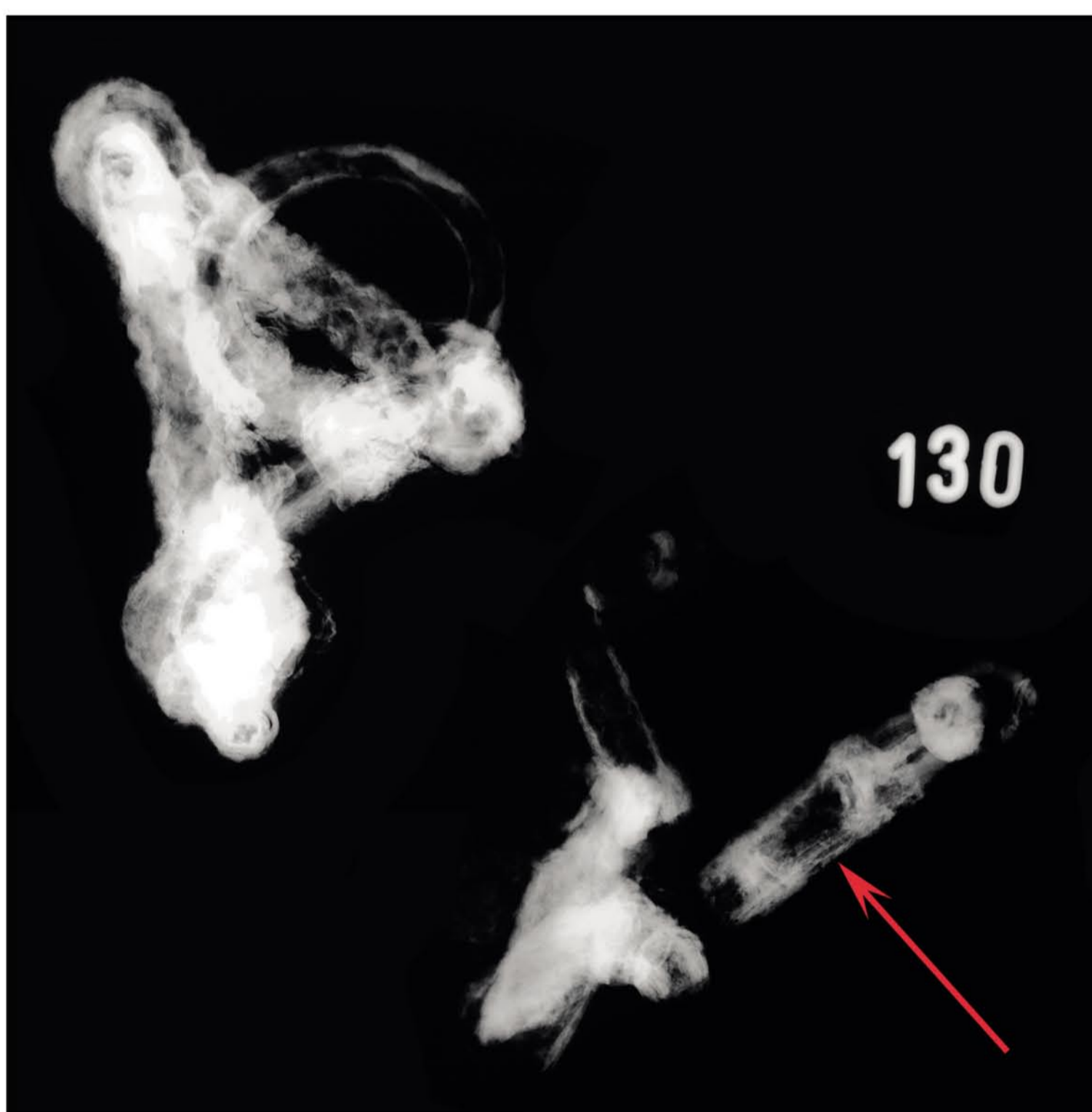
RADIOGRAM NA KOJEMU SE JASNO VIDI DA SU OKOVI UZDA IZRAĐENI OD ŠUPLJEG LIMA I SPOJENI ZAKOVICAMA (OZNAČENO STRELICOM)
